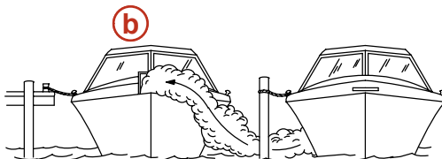
b - Zaczumowanie tuż przy innej łodzi, której silnik pracuje.
