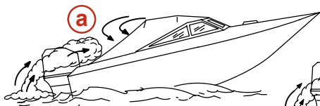
a - Pływanie łodzią przy zbyt dużym kącie przegłębienia dziobu.
